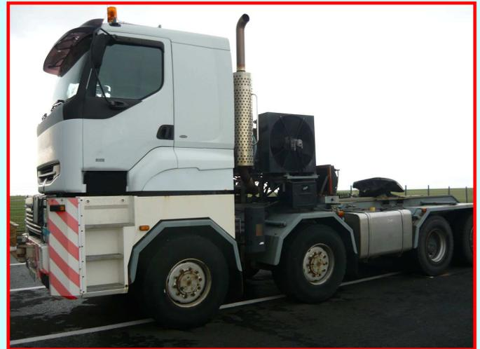
C'est un camion de marque TITAN construit avec des éléments de chez RENAULT TRUCKS , qui appartenait aux transports LEMARECHAL spécialiste des transports de déchets radioactifs , et d'éléments lourds pour les centrales nucléaires . Sous sa cabine de PREMIUM se dissimule un **V8 MACK de 560 cv** accouplé à une boîte mécanique ZF type 16S251 avec convertisseur de couple
